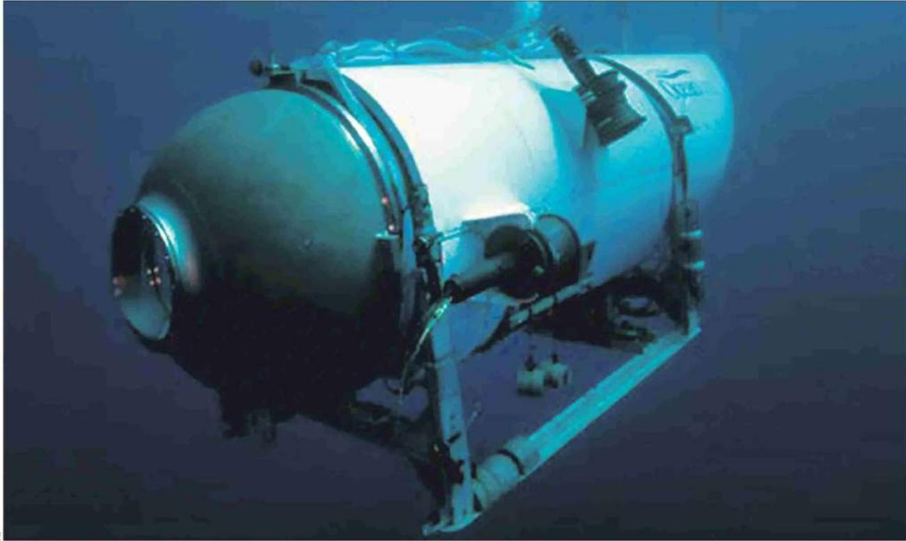
"El material utilizado para el casco del Titán era un compuesto de fibra de carbono. Es bien sabido que bajo cargas de compresión, las fibras de dichos compuestos son susceptibles al micropandeo y que pueden deslaminarse de la matriz que las rodea", dijo Roberto Ballarini, a cargo del equipo que realizó las simulaciones.
