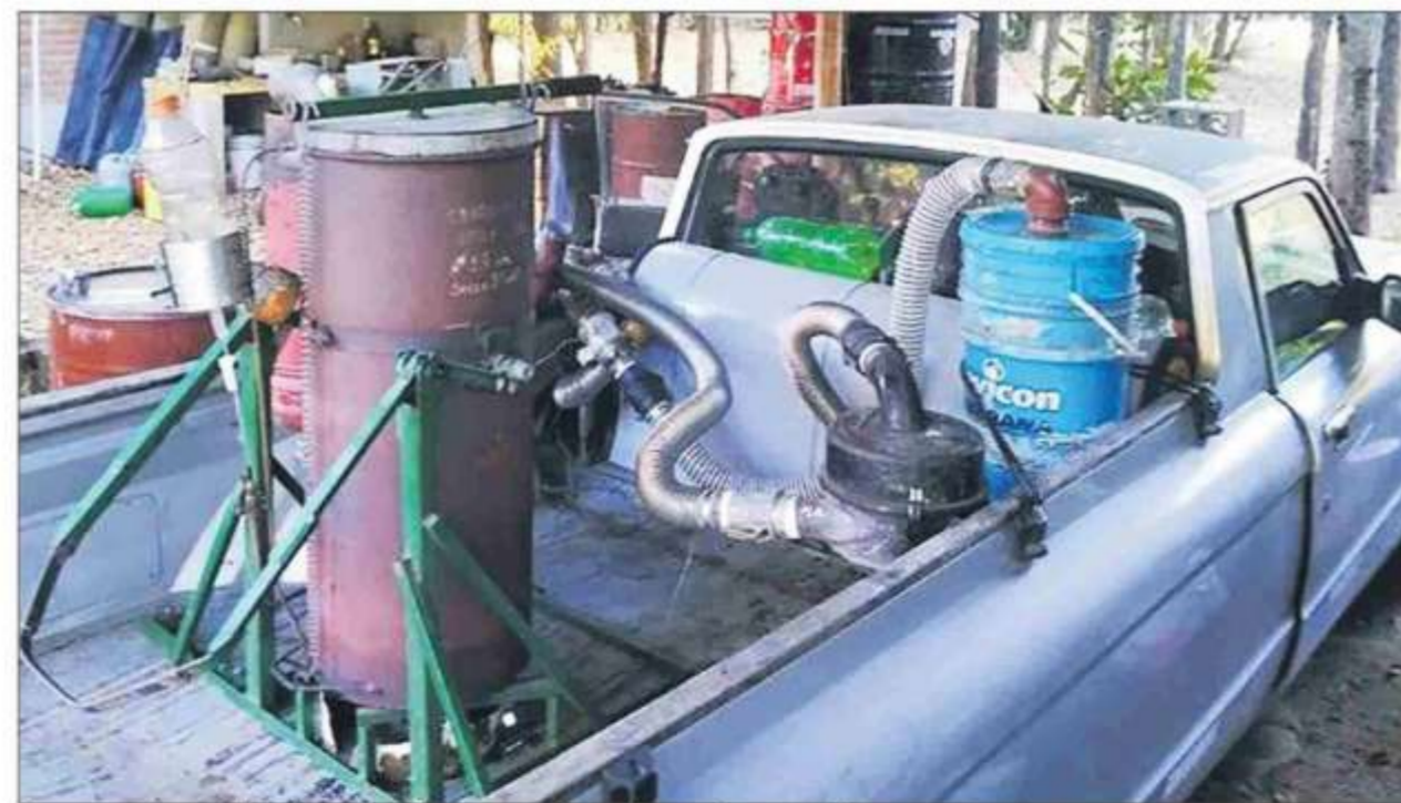
Ese es el gasificador, donde se combustonan los residuos y se separa el monóxido de carbono.
